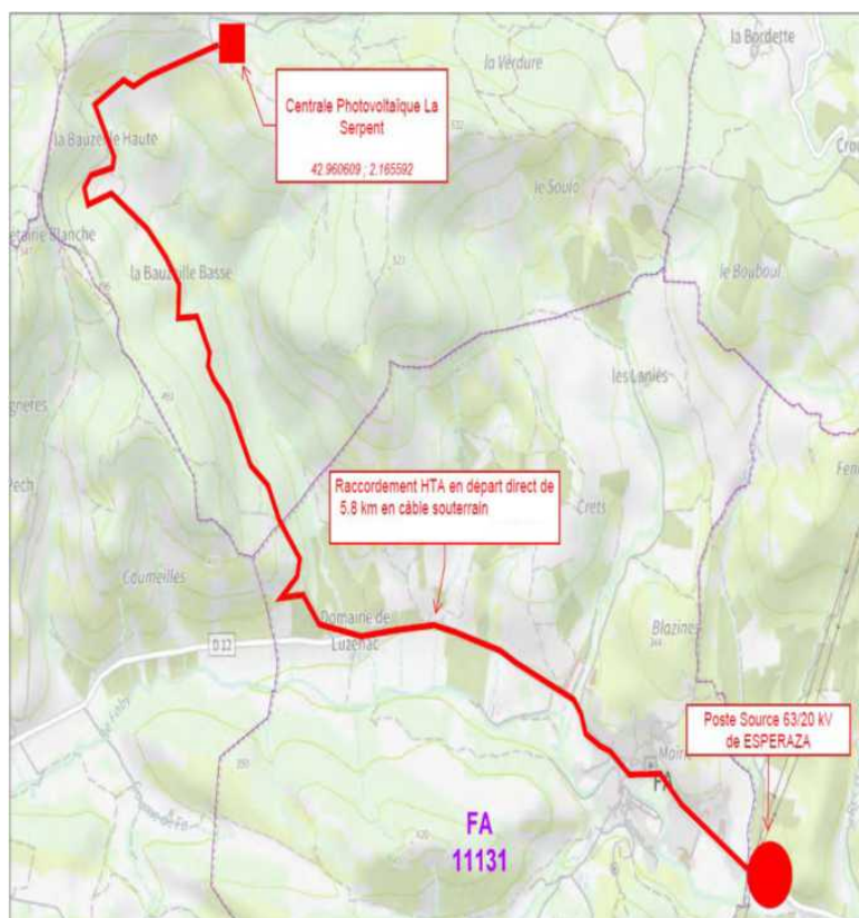
Figure 3: Schéma de la proposition de raccordement ENEDIS
